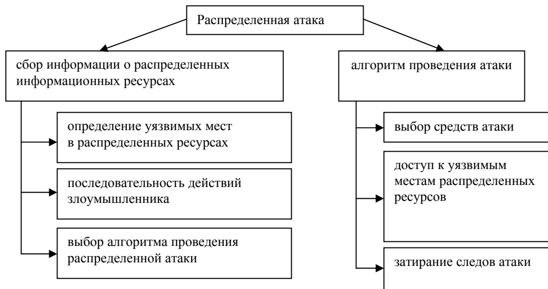
Рис. 1. Этапы проведения распределенной атаки на распределенные информационные ресурсы мобильных устройств
