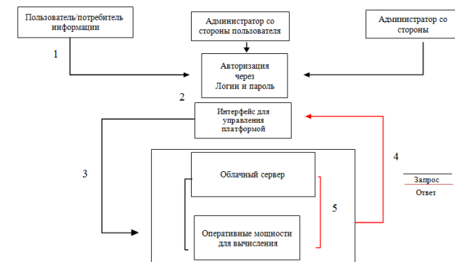
Рисунок 2 – Схема работы облачной САБУ при отработке запросов
