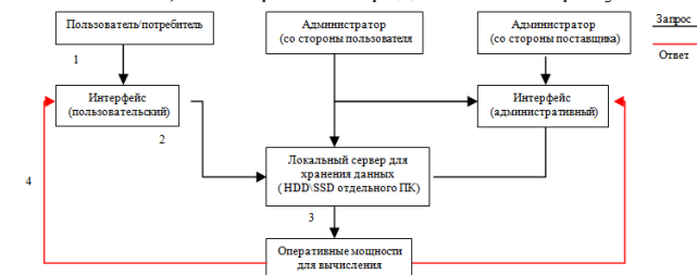
Рисунок 1 – Схема работы стационарной САБУ при отработке запросов
